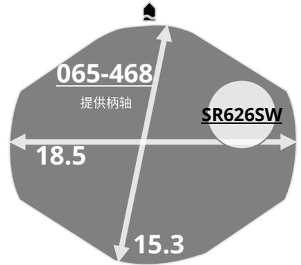
当拔出柄轴时电，电池处于最低消耗状态
