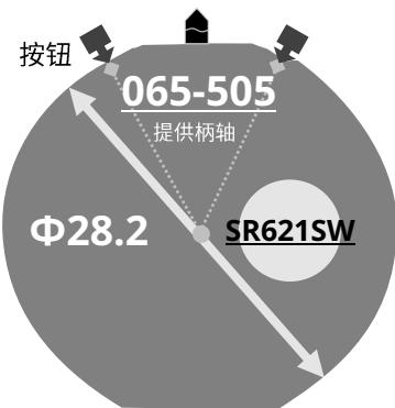
当拔出柄轴时电，电池处于最低消耗状态
